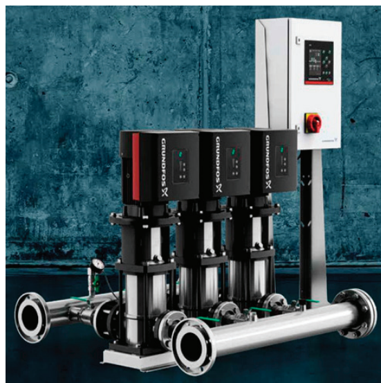
图 3: 由电机自带变频器的E泵组成的多泵并联成套机组，可根据用水量需求，快速提升或降低泵组输出流量，与普通的端吸泵或中开泵相比，能够满足更宽范围的流量需求，并且高效范围更宽。
