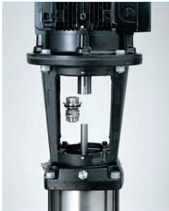
图 2: 由于采用了易于拆装的集装式机械密封，因此，立式多级离心泵的机械密封更换简单易行，无需拆卸电机，只需几分钟即可完成。这样，就可省掉在带弹性联轴器联接的端吸泵和中开泵上更换密封后重新对中电机轴和泵轴所需的时间和精力。
