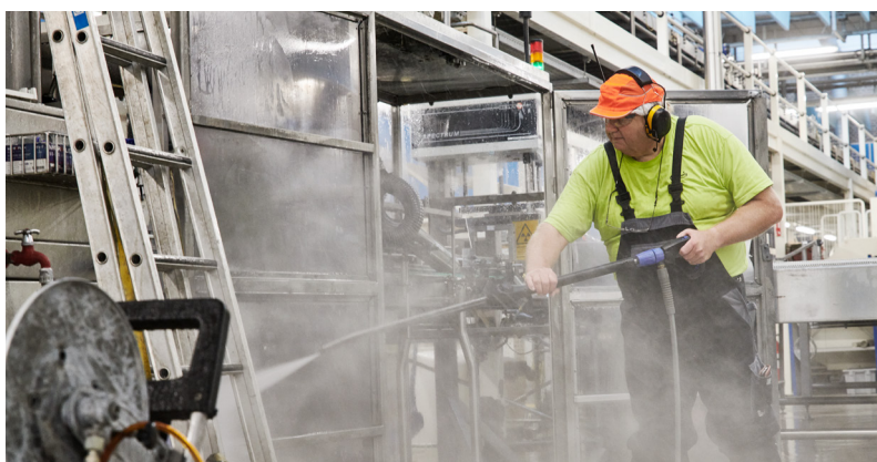
工艺水用于清洗工厂内的设备、地板、表面、管道和水箱、洗瓶和洗罐机等。
